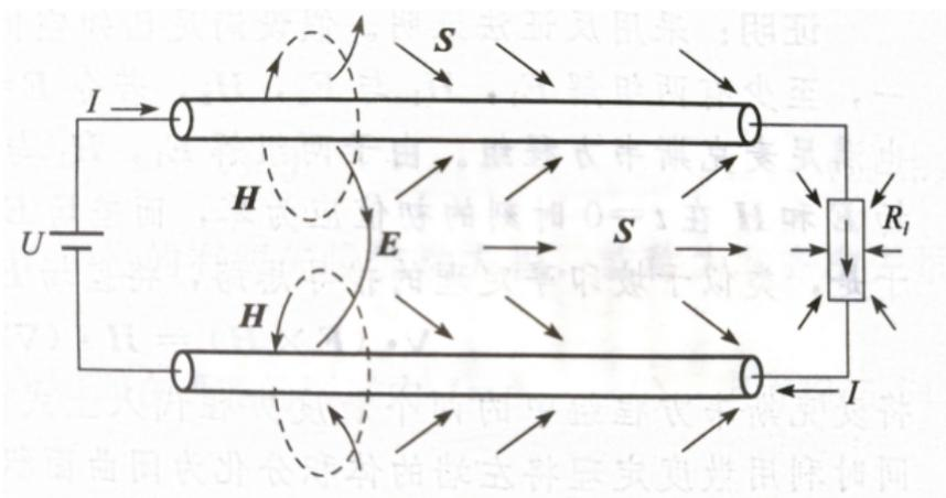
Figure 1: 有耗平行双导线周围空间中的电磁场和坡印廷矢量的分布
